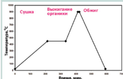
Рис. 4 Температурный профиль для обжига низкотемпературной совместно обжигаемой керамики
